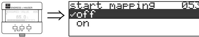
Esta função é utilizada para iniciar o mapeamento de eco de interferência até a distância dada em "range of mapping" (052).
