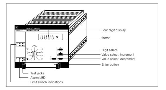
Fig. 1.1 Gammasilometer Fig. 573 Z/S
