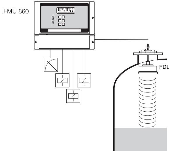
**d Kurzanleitung Füllstandmessung**
