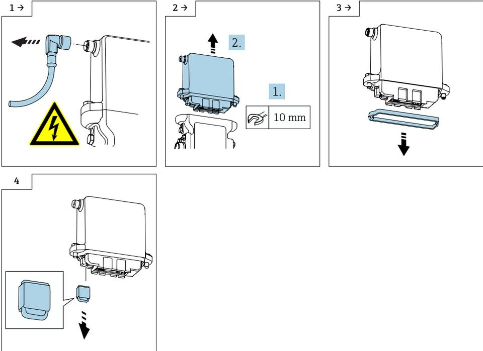
**i** M-DAT abziehen und in das neue Elektronikmodul einstecken. Die Prozess- und Sensorparameter werden damit in den neuen Messumformer übertragen.
