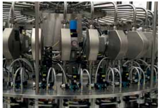
Machine de remplissage rotative équipée de débitmètres Dosimass
