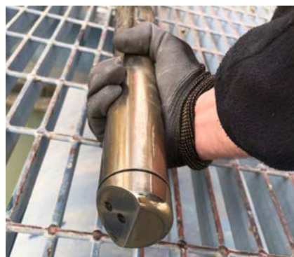
Der Trübungssensor Turbimax CUS52D wird im offenen Kanal des zurückgewonnenen Wassers installiert, die Montage erfolgt in der mechanischen Struktur der Brücke des Eindickers Nr. 2
