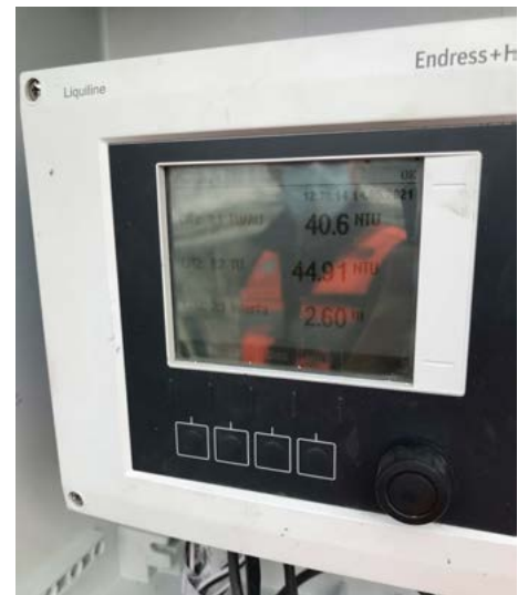
Liquiline CM442 zeigt die Messwerte an: Kanal 1: Turbimax CUS50D (Geprüftes Gerät) Messwerte liegen unterhalb des Messbereichs des Geräts. Kanal 2: Turbimax CUS52D. Kanal 3: Turbimax CUS71D
