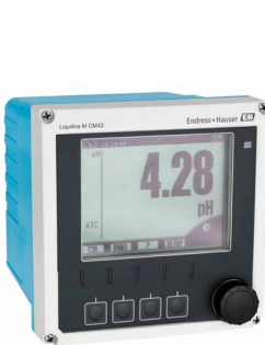
Transmetteur Liquiline M CM42 et capteur de pH Memosens CPS77D (ISFET)
